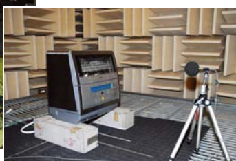
▲食器洗い乾燥機の音響測定
